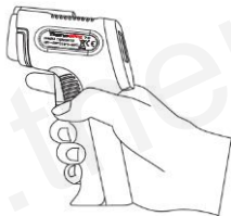
A ravaszt engedje fel. A mért hőmérsékleti adatok elmentve lesznek
